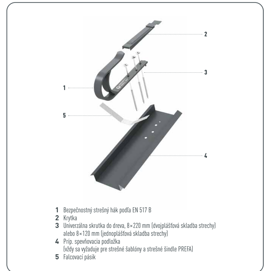
Obrázok 101 · Bezpečnostný strešný hák - potrebný materiál
