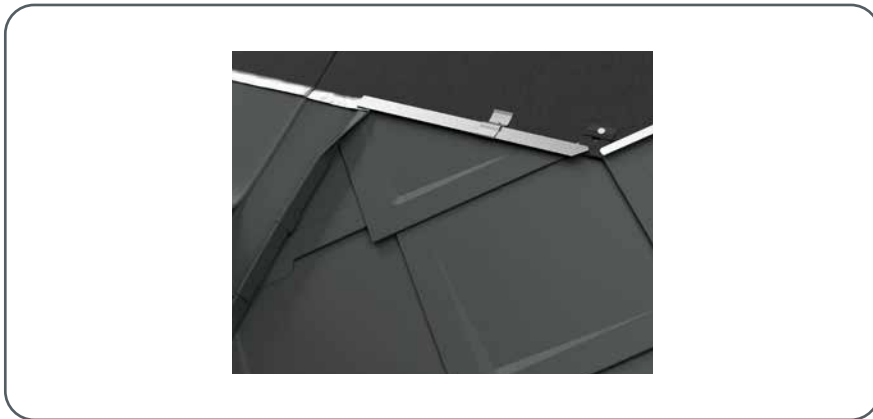
Obrázok 112 • Povalové okno - špecifikum pri strešnej šablóne 29×29 a 44×44
