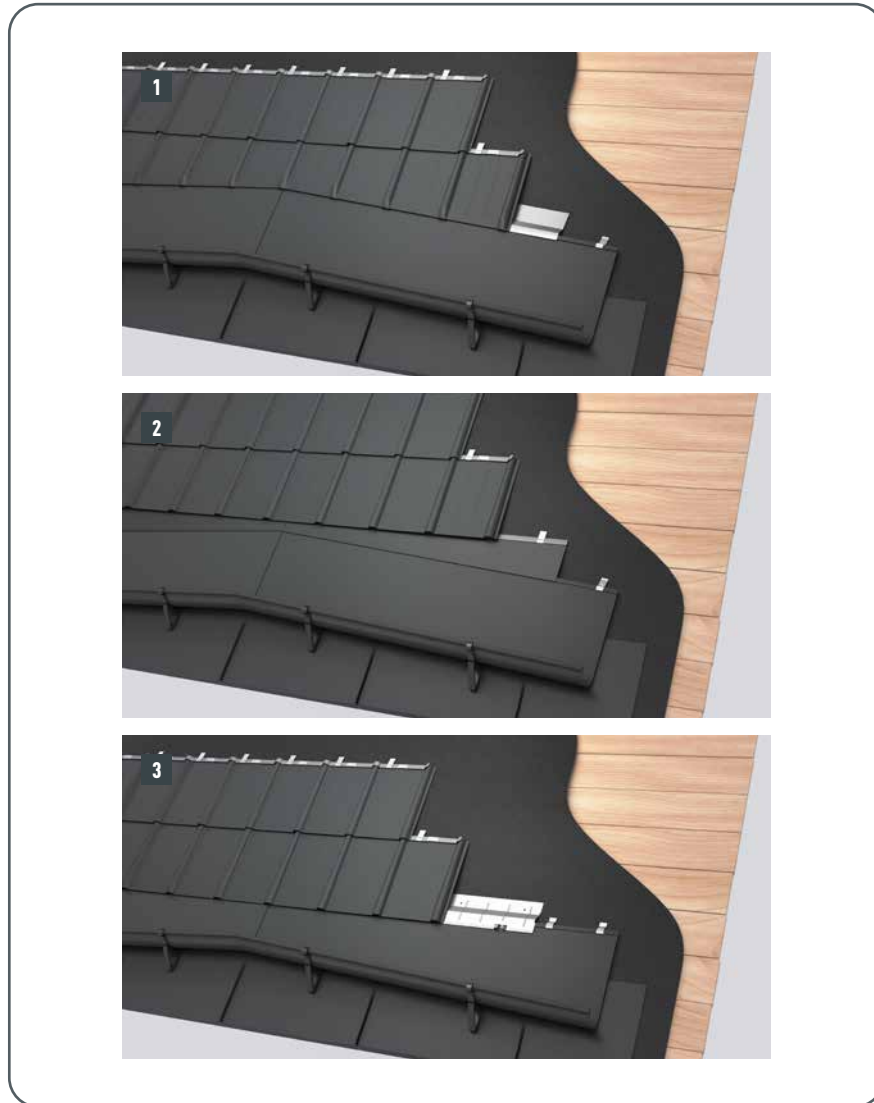
Obrázok 76 • Napojenie na nástrešný žľab
