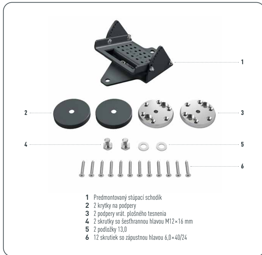
Obrázok 92 · Stúpací schodík - potrebný materiál
