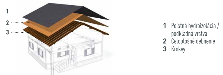
Obrázok 4 • Jednoplášťová skladba strechy
