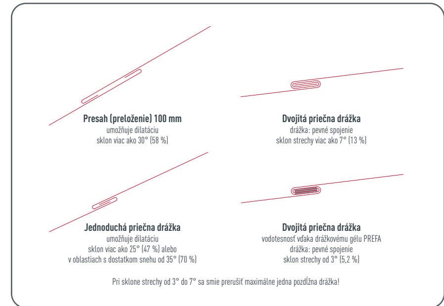
Obrázok 14 · Varianty vytvorenia priečnej drážky
