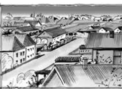
Kategória územia III - oblasti so súvislejšou vegetáciou a zástavbou, alebo s jednotlivými objektmi s rozstupom menším ako 20-násobok výšky prekážky (napr. dediny, predmestská zástavba, lesné oblasti)
