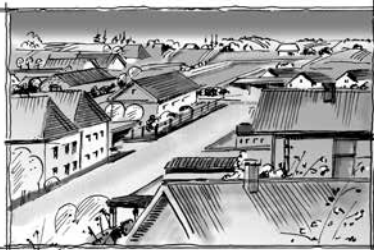
Obr. 3: Územní kategorie II - oblasti s nízkou vegetací a jednotlivými větrnými překážkami (stromy, budovy) s rozstupem min. 20 x výška překážky.
